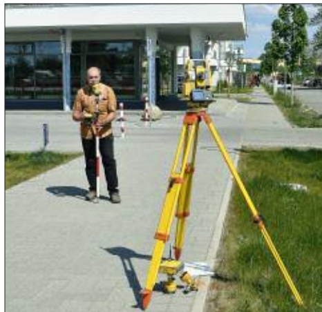
■ Moderne Technik wie die Totalstation hilft Thomas Dallorso schnell zu arbeiten.
