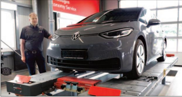
■ Der beliebte „VW ID.3“ kann bei Björn Raschick nun auf der modernen Vier-Stempel-Unterflur-Hebebühne repariert werden.
